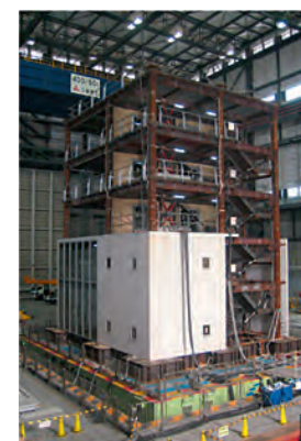
Fig. 26: Essais sur tables vibrantes en vraie grandeur au Japon (E-Defence).
