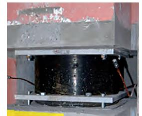
Abb. 4: Mit zusätzlicher Dämpfung kann die Erdbebeneinwirkung so weit reduziert werden, dass ein genügendes Verformungsvermögen auftritt. Hochdämpfendes Gummilager zur seismischen Isolation.
