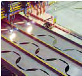
Cellular-Beams oder Lochstegträger sind leichter und geeignet für die Leitungsführung. Rechts: Topfloor-Integral-Träger.
