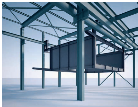
Image en 3D de la charpente métallique existante et de la nouvelle structure, qui s'intègre naturellement à l'existant.
