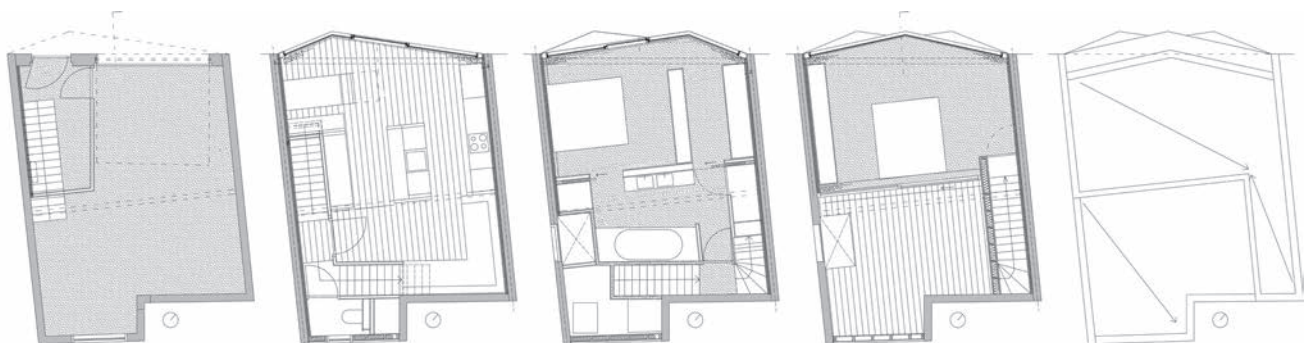
De gauche à droite : rez-de-chaussée avec entrée et garage ; 1 er étage avec cuisine et séjour ; 2 e étage avec chambre à coucher et salle de bains ; 3 e étage avec chambre et terrasse ; toiture ; échelle 1:200.
