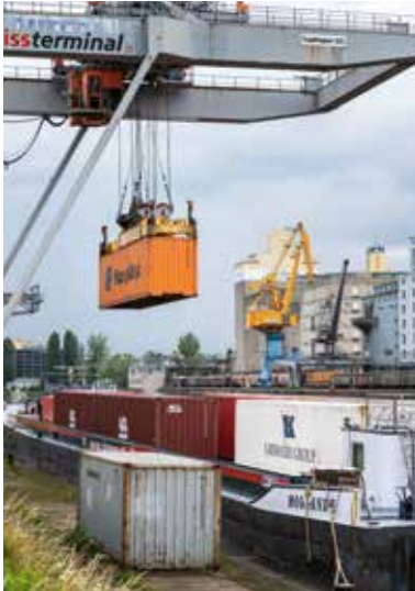
Im Rheinhafen Basel Kleinhüningen werden Schiffscontainer vom Wasser auf Bahn und LKW verladen.
